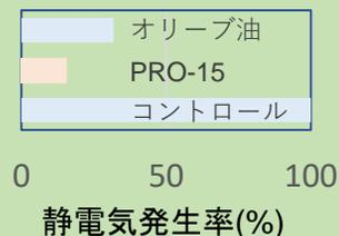
ヘアオイルを塗布し60°C下にて乾燥させた後、コーム試験による静電気の発生量を測定
